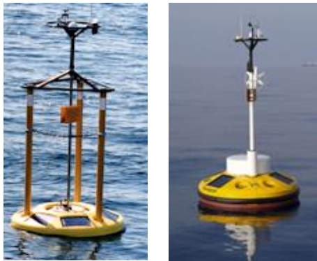
Εικόνα 3: Τα δύο είδη πλωτήρων του ΠΟΣΕΙΔΩΝΑ, Seawatch (αριστερά) and WaveScan (δεξιά).
