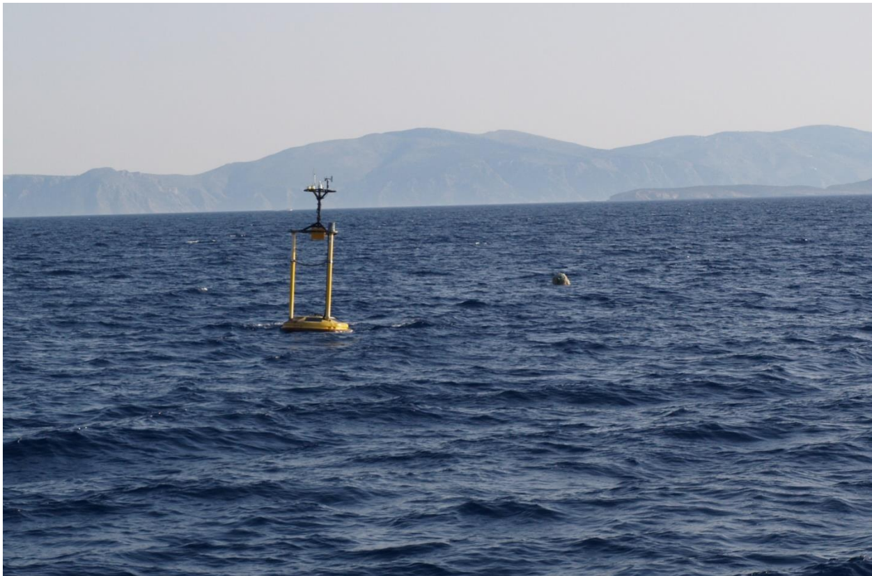
Εικόνα 49: Η σηματοδούρα του Σαρωνικού χωρίς βάρος αγκύρωσης. Στα βάθος φαίνεται ο υποβρύχιος πλωτήρας.
