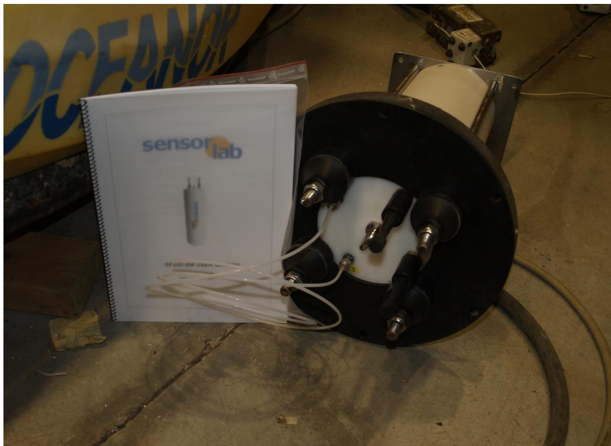
Εικόνα 34: Ο αισθητήρας pH, SP200-SM συναρμολογημένος με τον κατάλληλο προσαρμογέα για τοποθέτηση σε πλωτήρα σηματοδύρας τύπου Wavescan.
