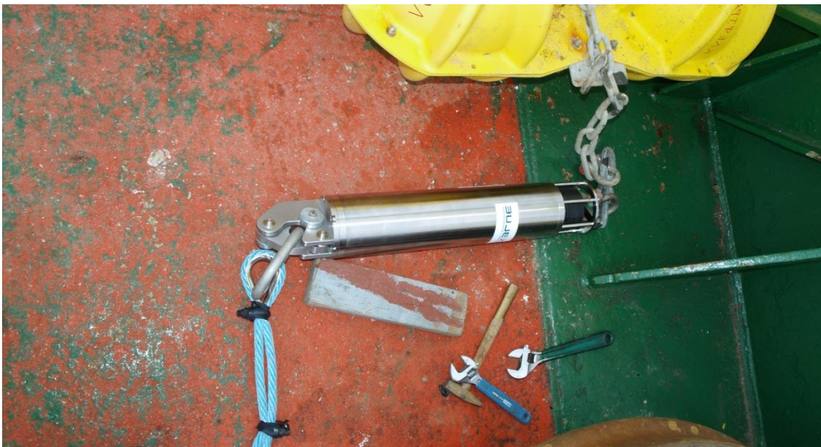
Εικόνα 24: Απελευθερωτής τύπου iXblue OCEANO 2500 τοποθετημένος στο αγκυροβόλιο της σημαδούρας του Άθω.
