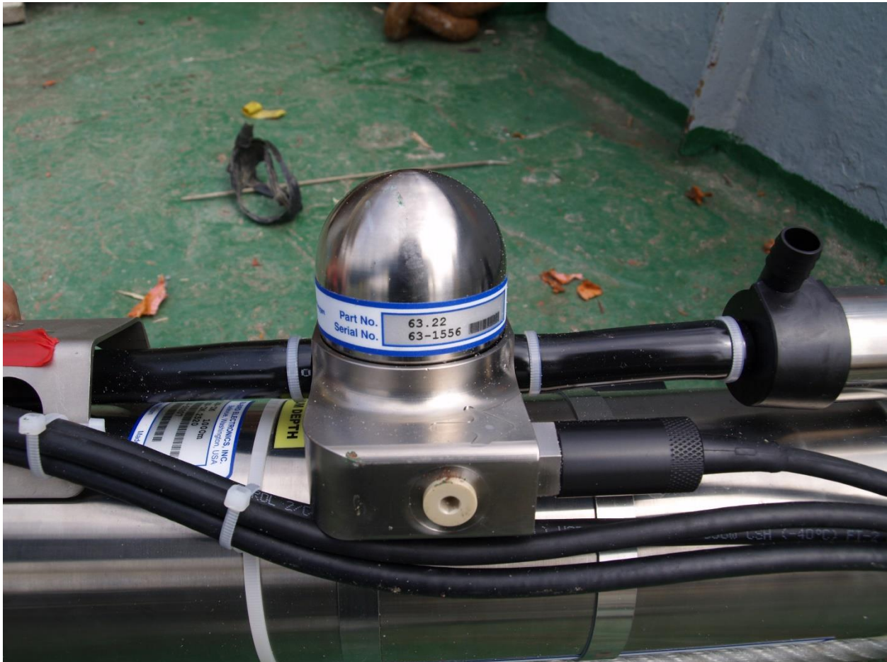
Εικόνα 18: Οπτικός αισθητήρας οξυγόνου τύπου SBE 63 της εταιρείας SEABIRD πάνω σε SBE 16 της σημαδούρας του Άθω.
