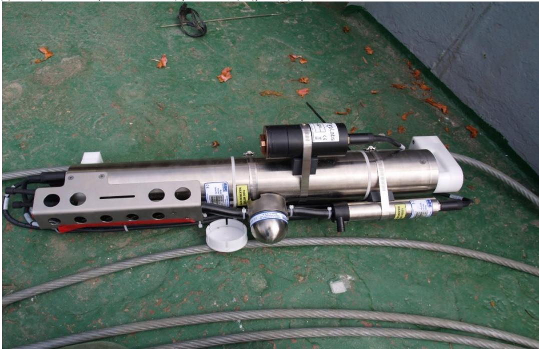
Εικόνα 17: Αισθητήρας CTD τύπου SBE 16 plus IM V2 της SEABIRD στο αγκυροβόλιο της σημαδούρας του Άθω.
