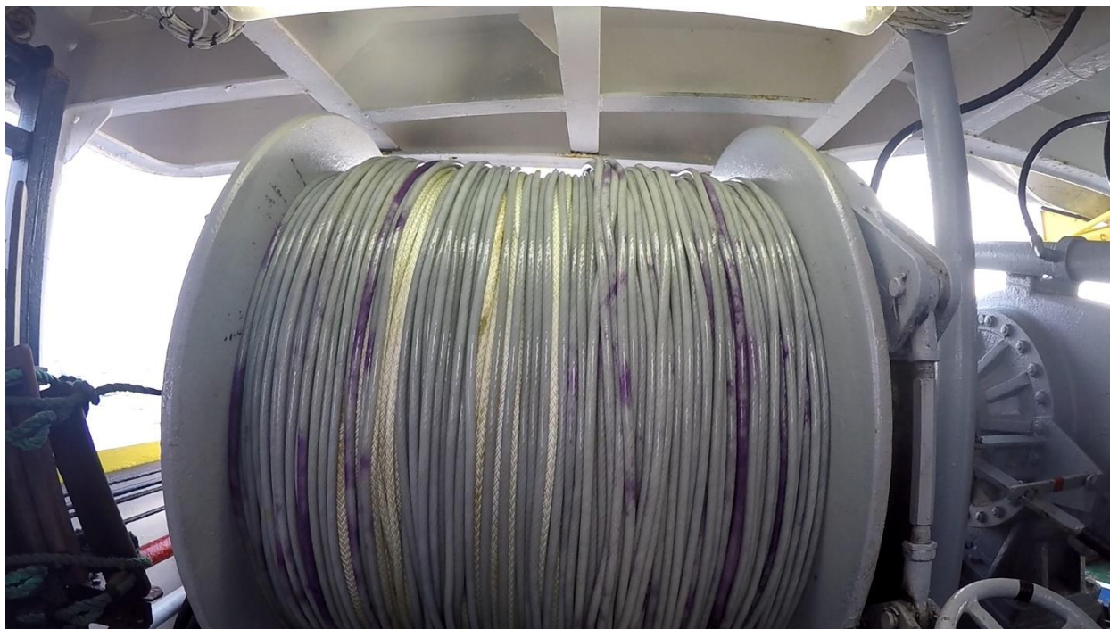
Εικόνα 39: Biofouling στο επαγωγικό καλώδιο της σηματοδούρας E1M3A (έντονο ιώδες χρώμα).
