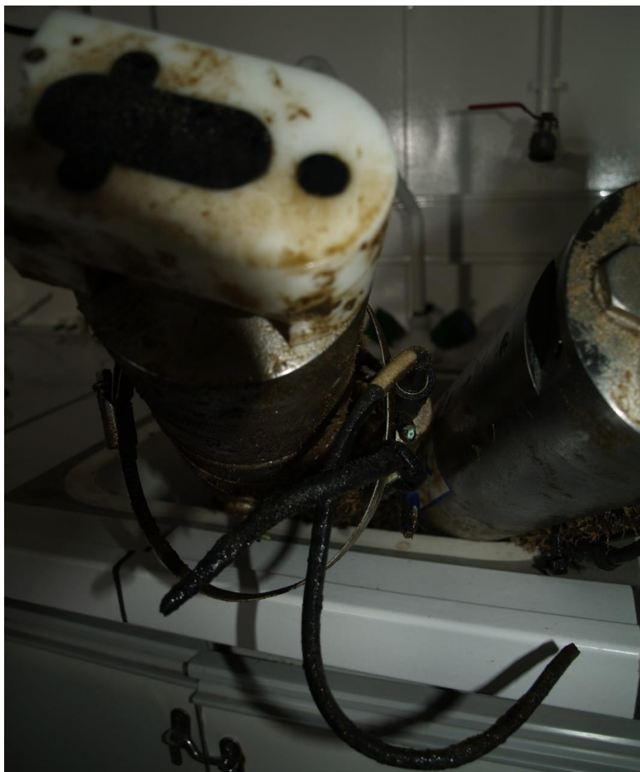
Εικόνα 15: Ο αισθητήρας CTD από τον οποίο χάθηκε ο αισθητήρας χλωροφύλλης (Πύλος). Διακρίνεται καθαρά ο δακτύλιος συγκράτησης του αισθητήρα και τα κομμένα καλώδια σύνδεσης.
