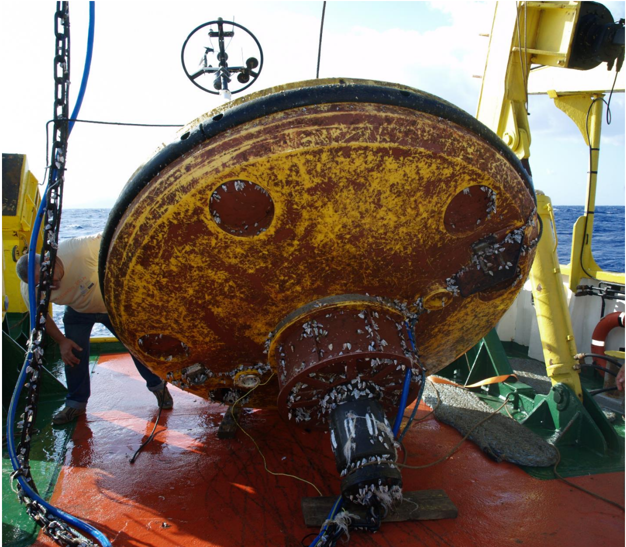
Εικόνα 10: Biofouling στους πλωτήρες της σημαδούρας της Πύλου.
