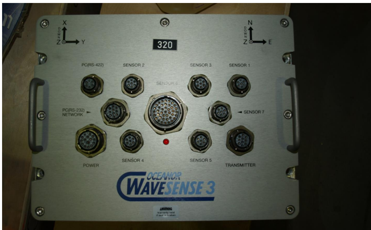
Εικόνα 42: Ο κυματογράφος και datalogger τύπου Wavesense 3 που τοποθετήθηκε στη σηματοδούρα της Πύλου.
