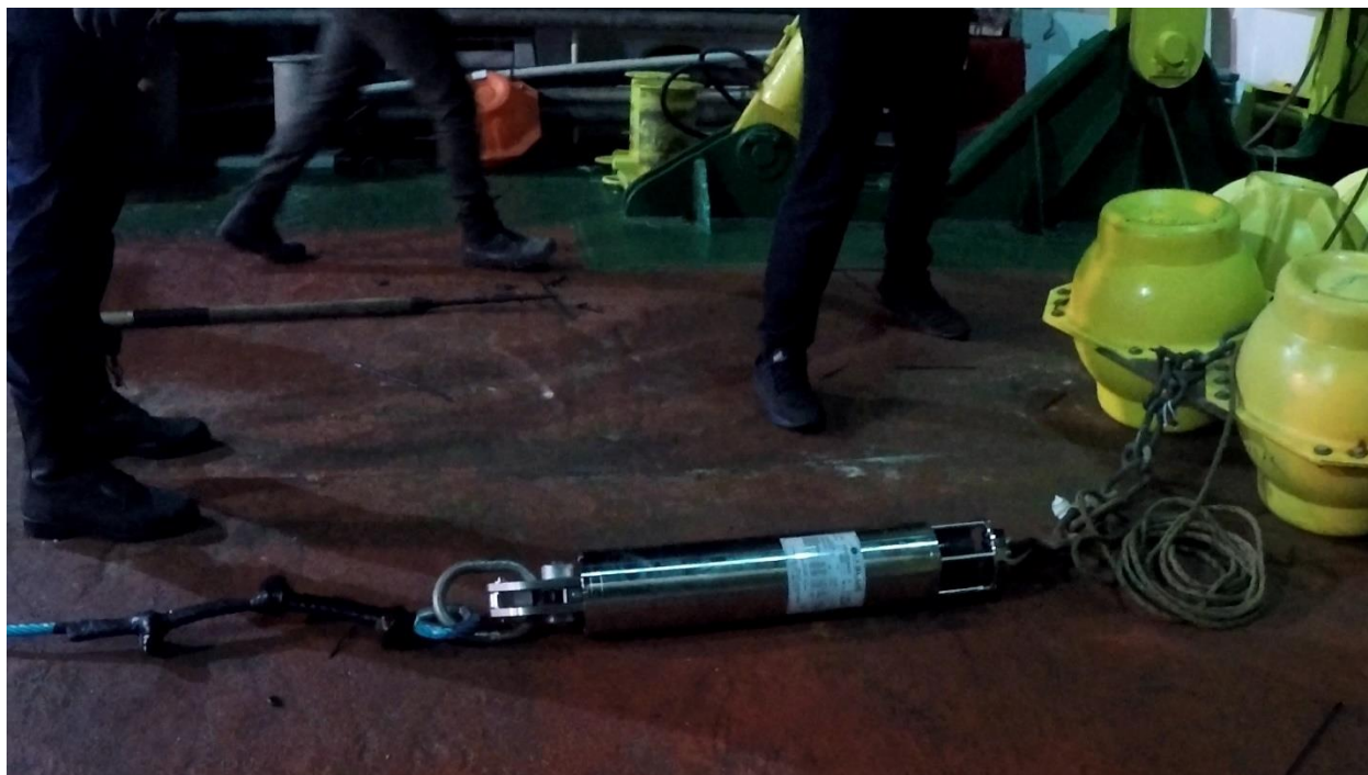
Εικόνα 44: Καινούριος απελευθερωτής OCEANO 2500 S της εταιρείας iXblue τοποθετημένος στο αγκυροβόλιο της σημαδούρας της Πύλου.
