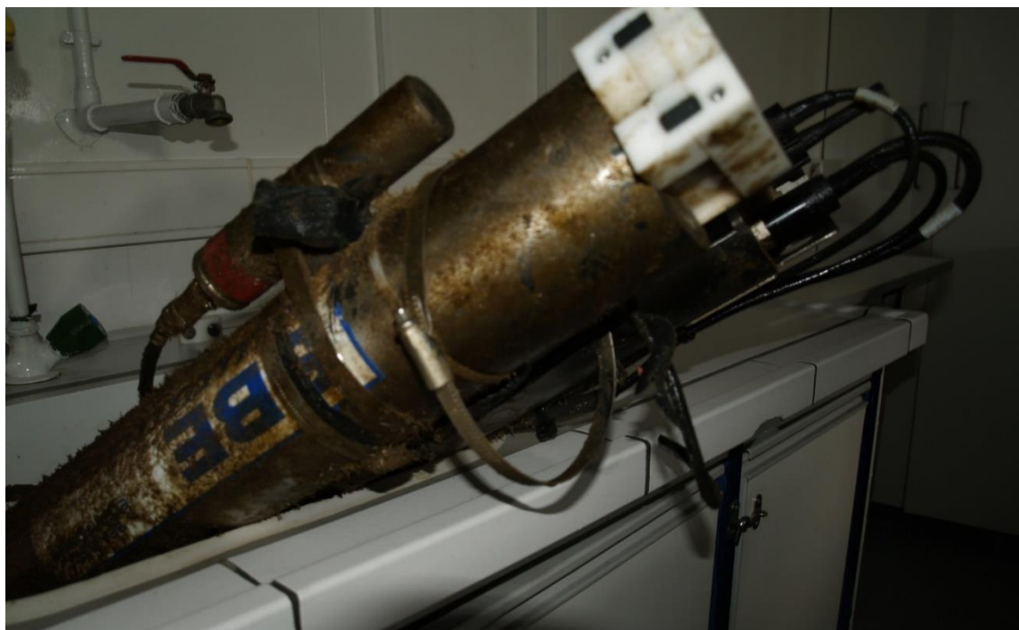
Εικόνα 13: Βiofouling σε αισθητήρα CTD SBE 16, ο οποίος φέρει αισθητήρα οξυγόνου της AANDERAA (Πύλος).
