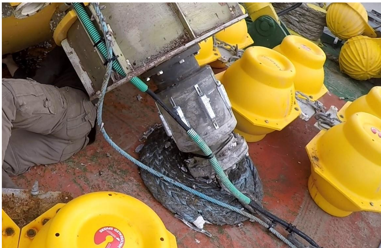
Εικόνα 37: Καινούρια ανόδια στο αντίβαρο της σημαδούρας.
