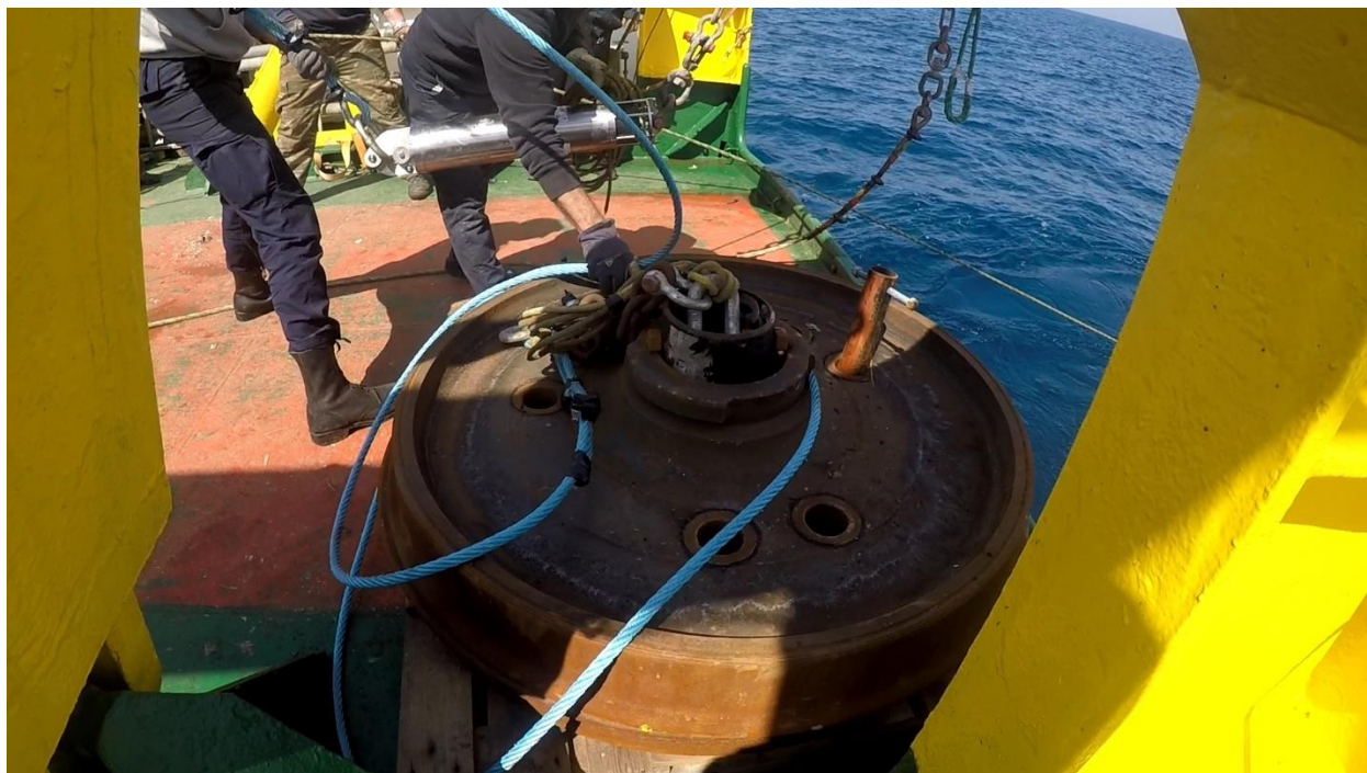
Εικόνα 25: Καινούριο βάρος στο αγκυροβόλιο της σημαδούρας του Άθω.
