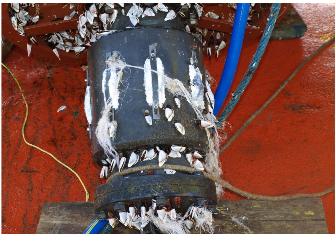
Εικόνα 12: Διαβρωμένα ανόδια στο αντίβαρο της δεξαμενής μετά από ανάσχυση της σημαδούρας της Πύλου.
