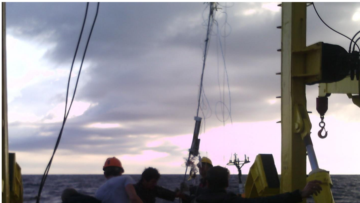
Εικόνα 2: Το επαγωγικό καλώδιο της σημαδούρας του Άθω μπλεγμένο με παραγάδια.
