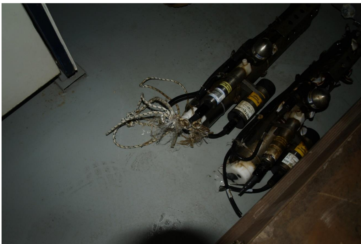
Εικόνα 14: Φθορές σε καλώδια αισθητήρων SBE 16 από πετονιές (Πύλος).
