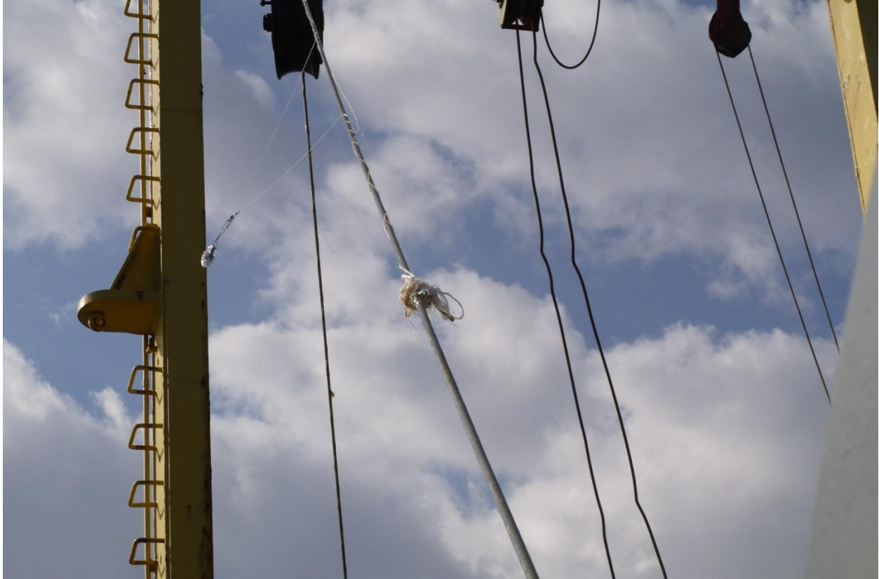
Εικόνα 9: Το επαγωγικό καλώδιο της σημαδούρας της Πύλου μπερδεμένο με παραγάδι.
