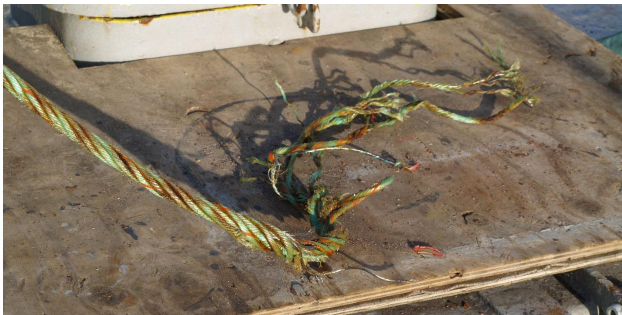
Εικόνα 50: Το σχοινόσυρμα του αγκυροβολίου της σημαδούρας του Σαρωνικού κομμένο από τράτα.
