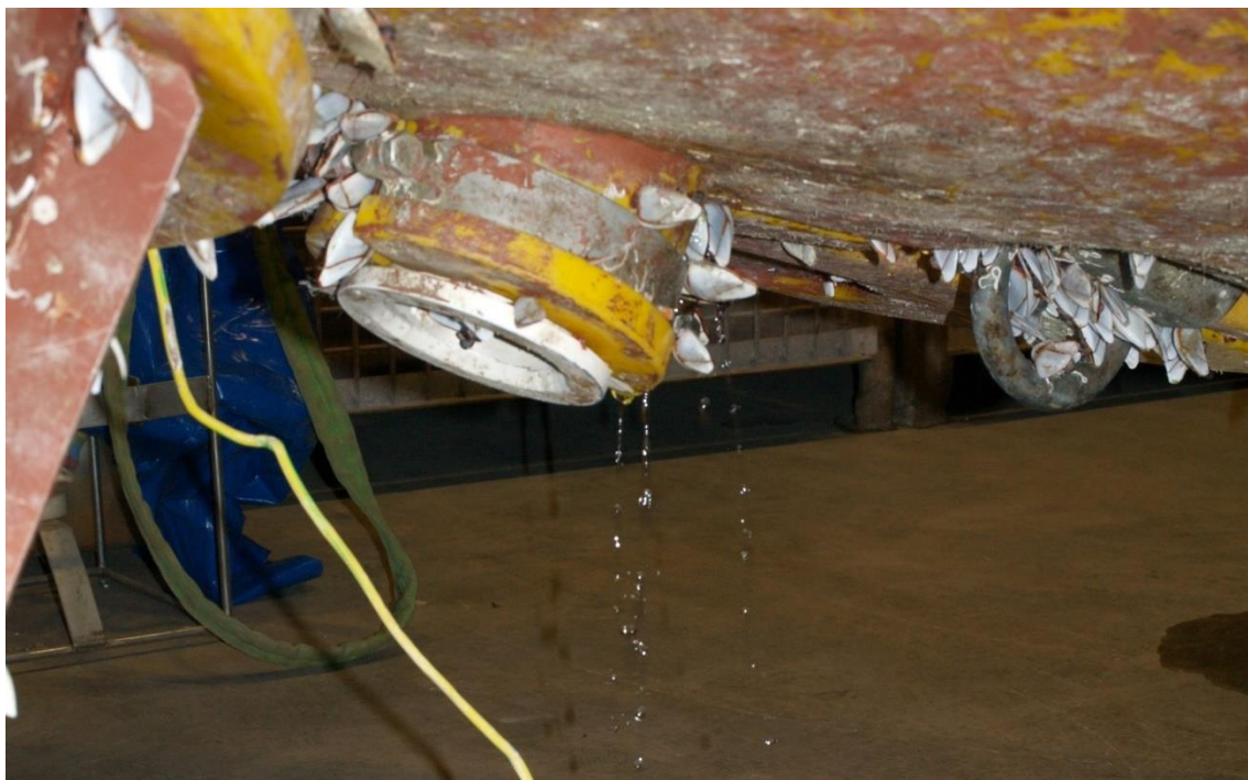
Εικόνα 11: Διαρροή από ρωγμή στον πλωτήρα της σημαδούρας της Πύλου.
