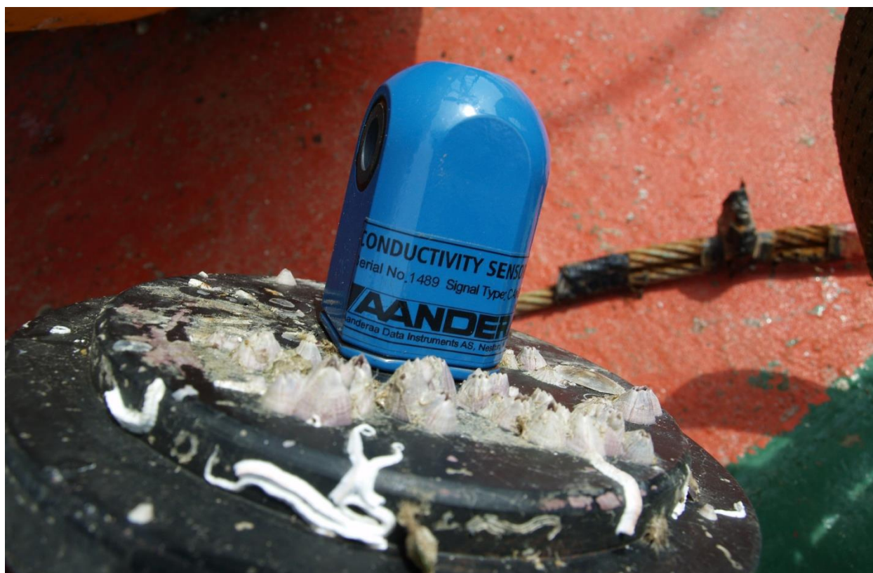
Εικόνα 22: Αισθητήρας CT 4319 της εταιρείας AANDERAA τοποθετημένος στη σημαδούρα του Άθω.
