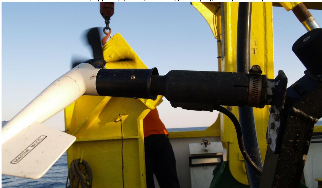
Εικόνα 48: Ανεμόμετρο της εταιρείας R.M. Young στον ιστό της σημαδούρας του Σαρωνικού.
