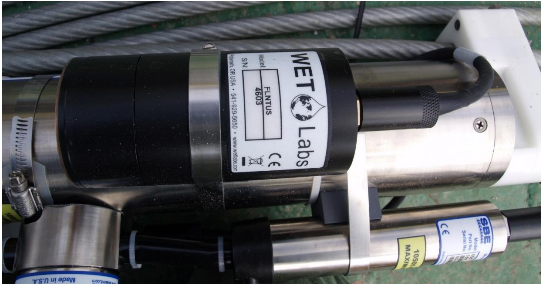
Εικόνα 19: Οπτικός αισθητήρας χλωροφύλλης – θολερότητας, ECO FLNTU της εταιρείας WET Labs τοποθετημένος σε SBE 16 της σημαδούρας του Άθω.
