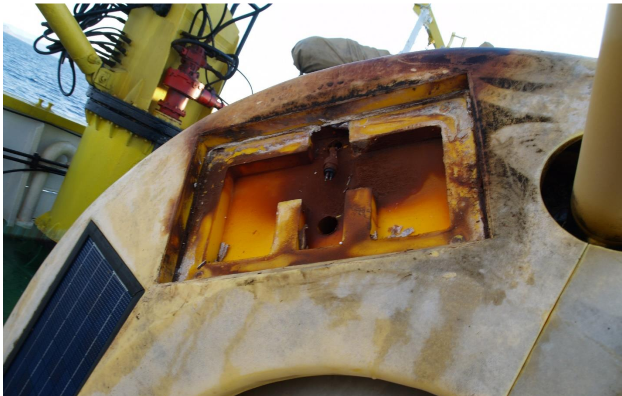
Εικόνα 46: Συσσωρευμένη λάσπη κάτω από ηλιακό συλλέκτη στη σημαδόουρα του Σαρωνικού.
