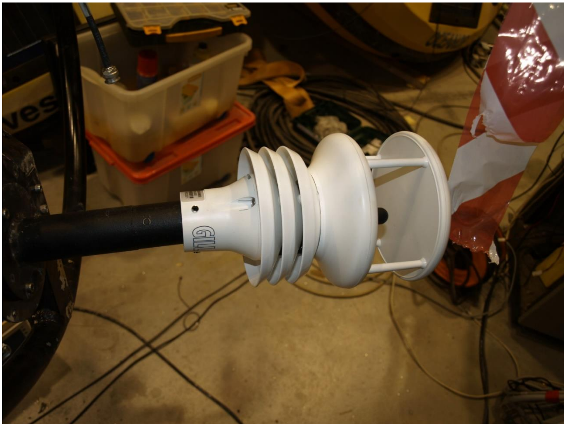
Εικόνα 27: Μετεωρολογικός σταθμός GMX600 της εταιρείας GILL τοποθετημένος στον ιστό της σημαδούρας της Μυκόνου.
