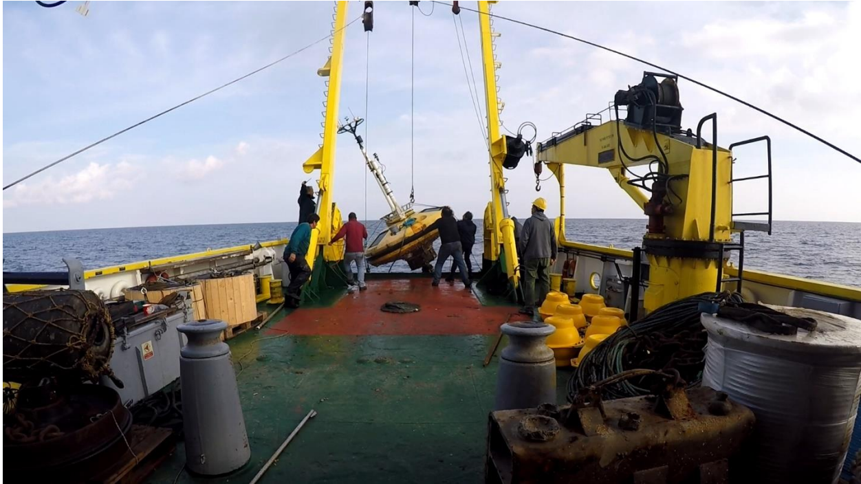
Εικόνα 31: Ανέλκυση της σημαδούρας E1M3A.
