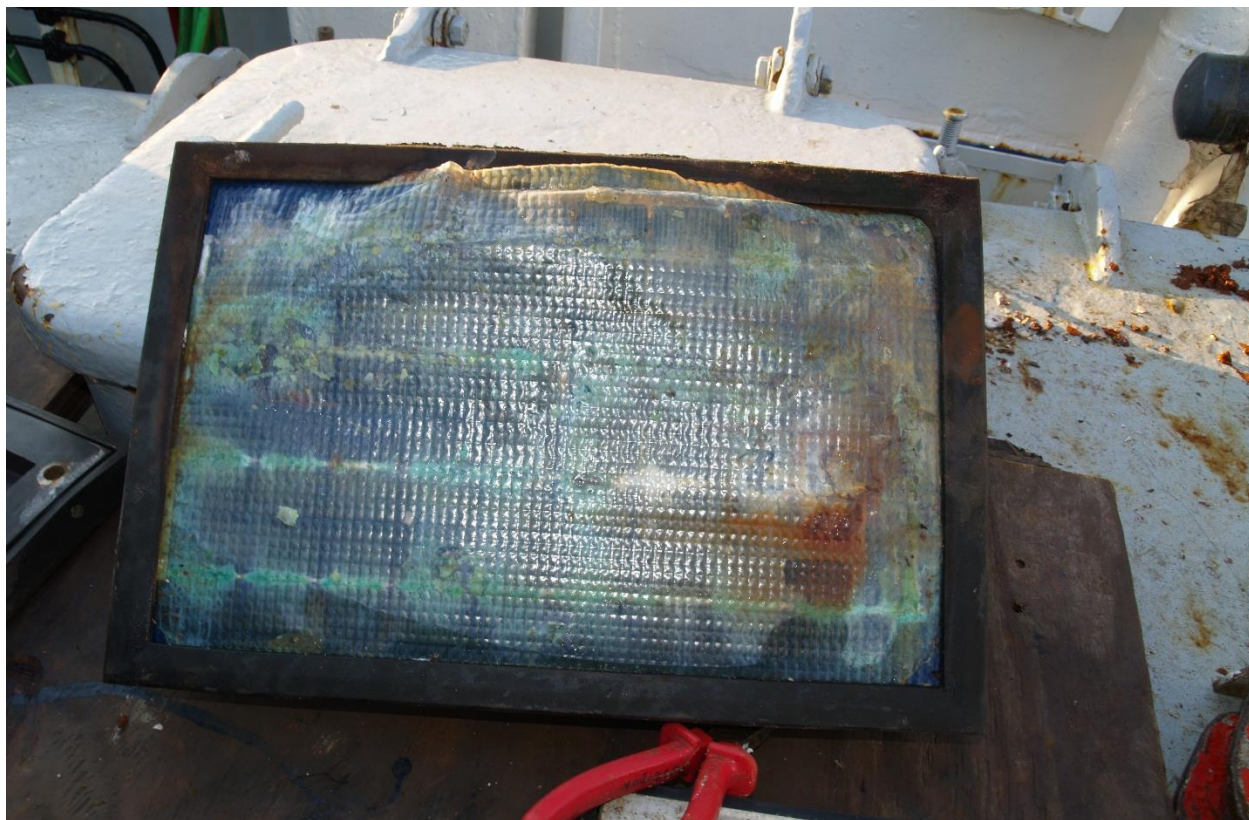
Εικόνα 47: Κατεστραμμένος ηλιακός συλλέκτης από τη σημαδούρα του Σαρωνικού.
