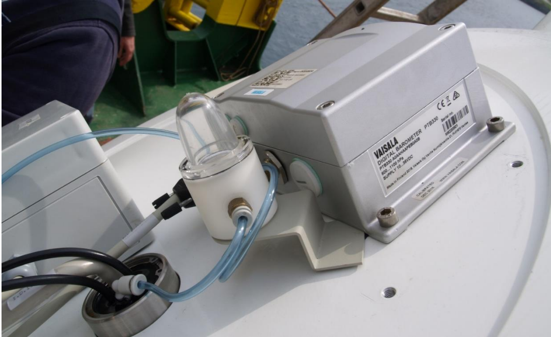
Εικόνα 23: Ψηφιακό βαρόμετρο PTB 330 της εταιρείας VAISALA τοποθετημένο στη σημαδούρα του Άθω.
