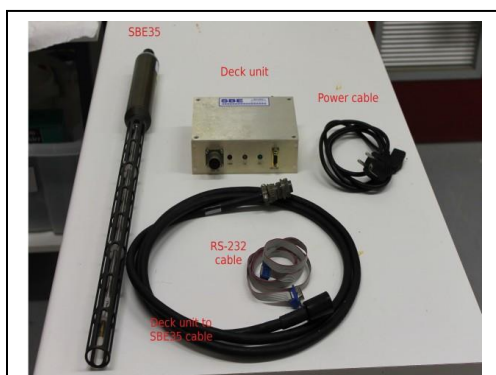
Εικόνα 4: Η διάταξη του θερμομέτρου αναφοράς SBE-35
