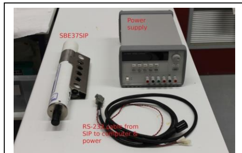
Εικόνα 5: Η διάταξη του σαλινόμετρου αναφοράς SBE- 37-SIP
