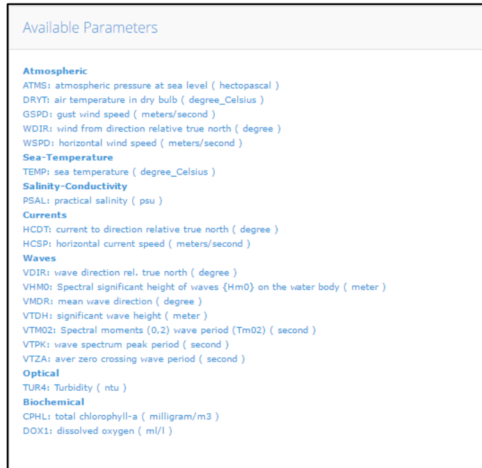
Εικόνα 11: Λίστα παραμέτρων που καταγράφονται από τον πλωτήρα
